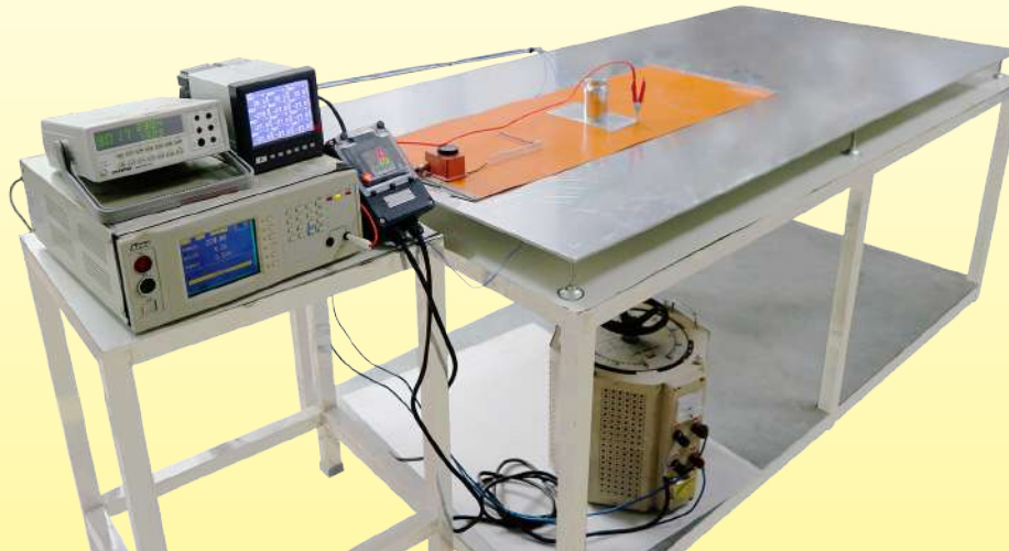
Equipo de medición para la corriente total de fuga en caliente
